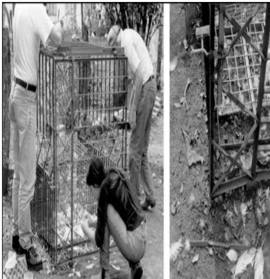
Foto 39: No detalhe, pedaço de grade danificado da armadilha, originalmente soldado. Foto: Carlos A. Machado
